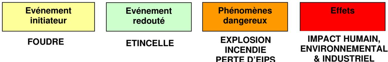
La foudre est un courant de forte intensité, 30 kA en moyenne avec des maxima de l'ordre de 100 kA, se propageant avec des fronts de montée extrêmement raides entre deux masses nuageuses ou entre une masse nuageuse et le sol.
