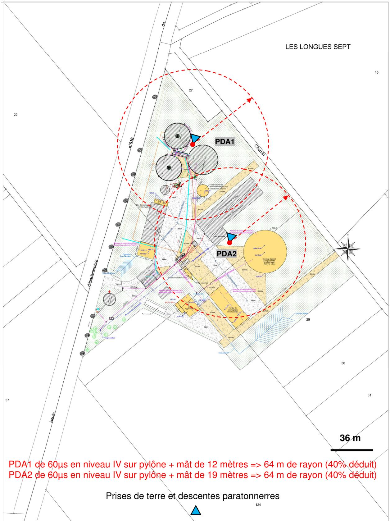
PDA1 de 60µs en niveau IV sur pylône + mât de 12 mètres => 64 m de rayon (40% déduit)
