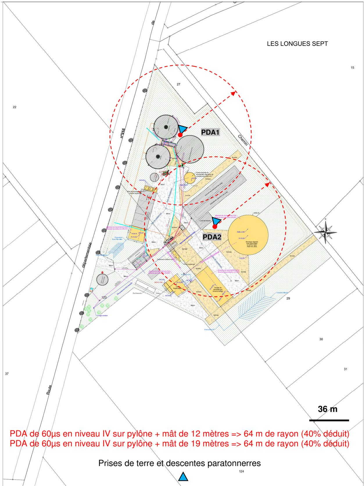
PDA de 60µs en niveau IV sur pylône + mât de 12 mètres => 64 m de rayon (40% déduit)
