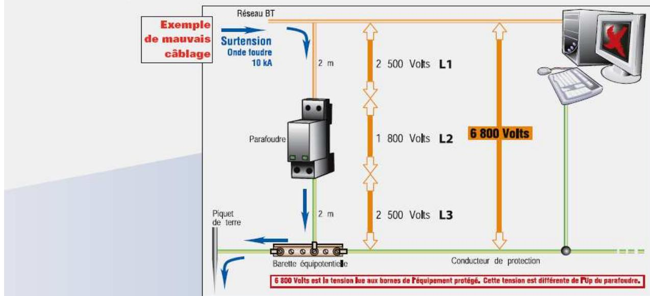
Une longueur de câble minimum entre les deux étages de protection doit être respectée de manière à assurer le découplage nécessaire au bon fonctionnement de la protection cascade.
