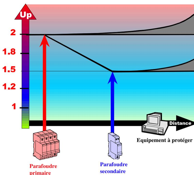
Le choix des parafoudres doit être fait en fonction de leur pouvoir d'écoulement en courant de décharge (facteur retenu pour les parafoudres primaires), de leur tension résiduelle (facteur important pour les parafoudres secondaires), de la tension nominale du réseau (généralement 400V triphasé), et du schéma de distribution du neutre (TN, TT, IT).
